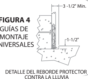
FIGURA 5 DETALLE DEL REBORDE
